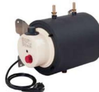
Dieser Boiler kann überall verwendet werden, wo wenig Platz und schwache Stromverhältnisse mit niedriger Ab-sicherung vorhanden sind. Der elektrischer Druckboiler (Edelstahl Ausführung), kann an jede Druck-, Hand-, Fuß- oder Tauchpumpe mit und ohne Rückschlagventil angeschlossen werden. Er ist aufheizbar von ca. 30° C - ca. 80° C. Bei voller Aufheizung vermischbar auf 10 Liter mit ca. 50° C, auf 15 Liter mit ca. 40° C. Wahlweise für 230 V, 12 V oder 24 V erhältlich.
