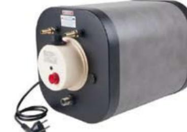
Speziell für Motor und Segelyachten, Reisemobile, Wohnwagen und Verkaufsfahrzeuge. Typ ME ist ein Kombigerät, es kann das Brauchwasser wie bei Typ M über das Motorkühlwasser oder im Stand wie bei Typ E über die eingebaute Elektroheizung erwärmen.
