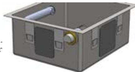
**Bei Topmount Installation der Spüle** (also Spülen von oben in die Arbeitsplatte eingesetzt) achte bitte darauf, dass du die Dicke deiner Platte berücksichtigst, im dem Fall muss das Loch tiefer angeordnet werden ( $z=30\text{mm} + \text{Dicke Arbeitsplatte}$ ), damit du auf der Rückseite noch die Mutter/Unterlegscheibe montieren kannst ohne das diese mit der Arbeitsplatte kollidiert (oder du musst deine Arbeitsplatte an dieser Stelle aussparen).
