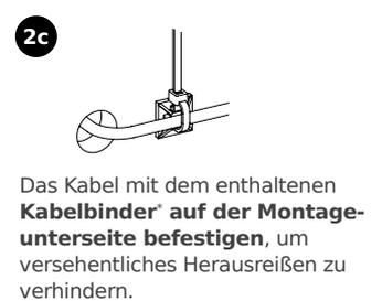
Das Kabel mit dem enthaltenen **Kabelbinder** auf der **Montageunterseite befestigen**, um versehentliches Herausreißen zu verhindern.
